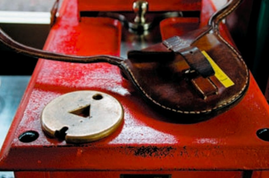
円盤状のタブレットと、それを入れて運ぶためのキャリア
