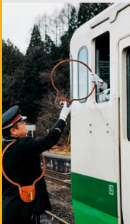
駅員と運転士との間で交換される タブレット（会津宮下駅）
