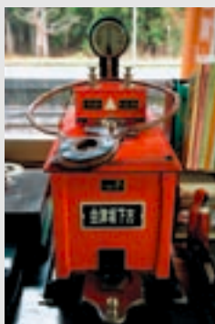
会津宮下駅のタブレット 閉塞機
