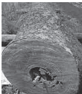
伐採した桐は玉切りの状態で置き、年輪や太さを見ながら、使用する部材ごとに厚さを決めて製材する
