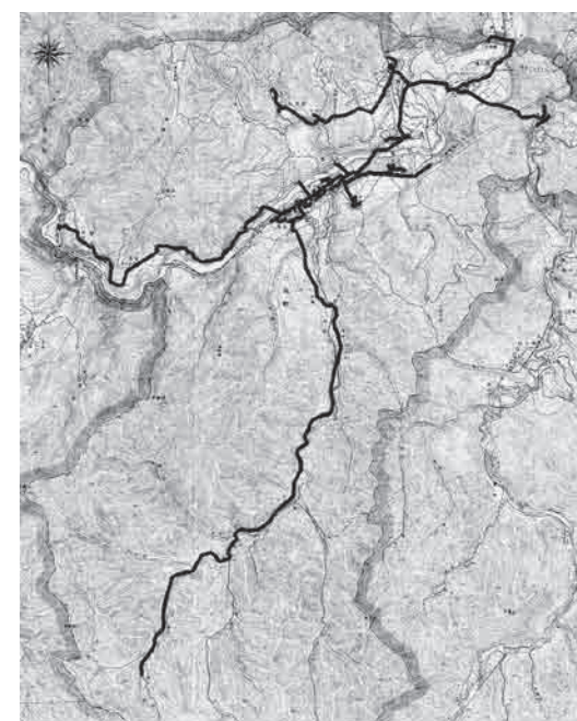
町内の幹線（黒色実線部分）に光ファイバーケーブルが整備されます。
