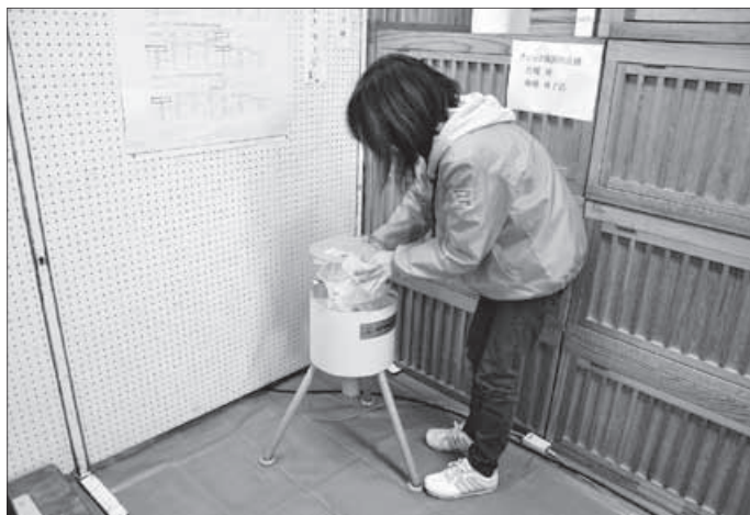
町では道の駅尾瀬街道みしま宿2階に放射能検査室を設置し、放射能簡易測定機により食品等の検査を実施している
