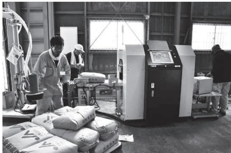
柳津営農経済センター 11号倉庫に設置された検査場で、柳津町内と三島町内で生産された米の放射能検査を実施している。生産者バーコードを貼り付けた玄米 30kgの袋を、一つ一つ測定機に入れ、放射性セシウム濃度を測定する。これまで基準値を超える放射性物質が検出された例はなく、安全に出荷されている
