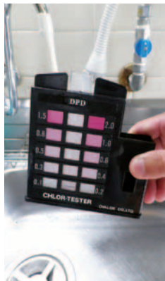
塩素濃度検査
