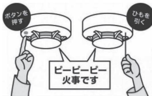
作動点検は住宅用火災警報器にあるボタンを押す又はひもを引くことで簡単に点検することができます。その際、ブザー又は音声は鳴れば正常に作動していることとなりますが、ブザー又は音声は鳴らない場合は、電池切れ又は故障が考えられます。取扱説明書を確認するか購入した電気店等に問い合わせましょう。また、機種によってはブザー又は音声で電池切れを知らせるものもあります。
